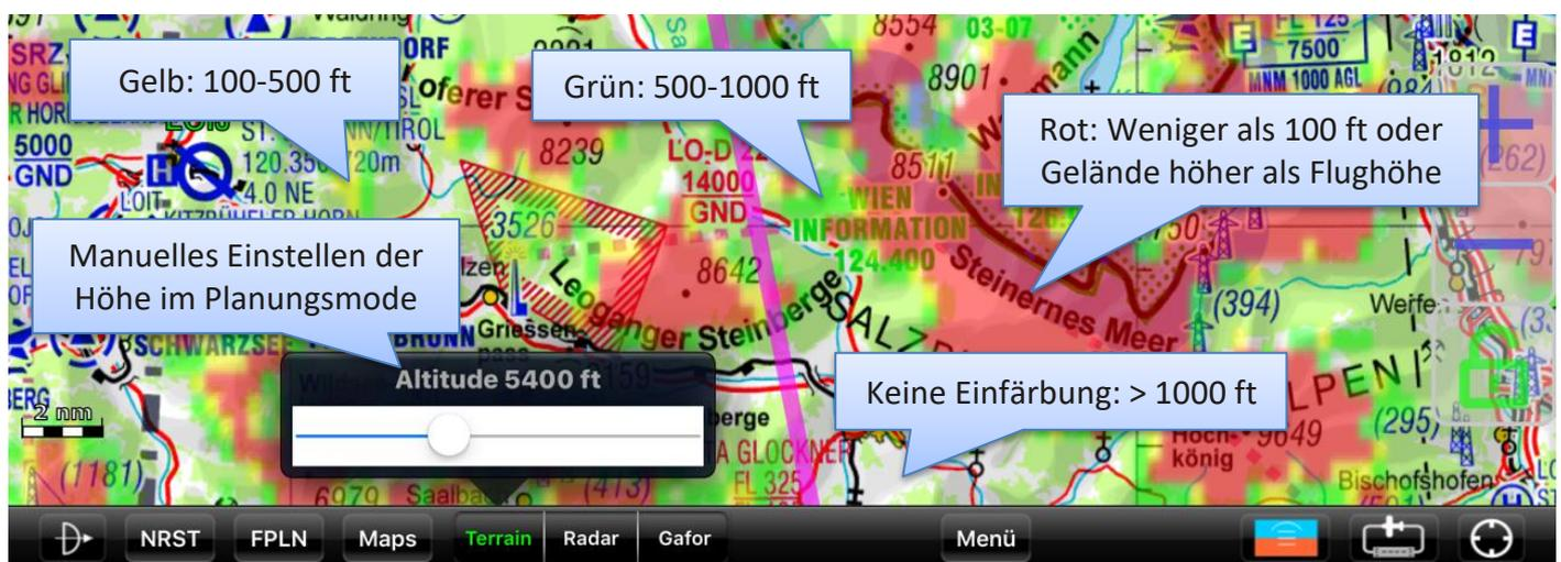
Im Moving Map Mode bezieht sich die Anzeige auf die aktuelle Flughöhe, im Planungsmodus kann die Höhe über den Schieberegler eingestellt werden (z.B. um einzuschätzen welche Höhe entlang einer geplanten Route nötig ist)
